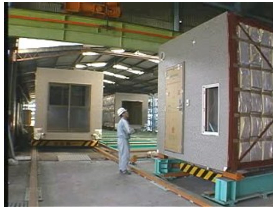
設備収納されたモジュールユニット
